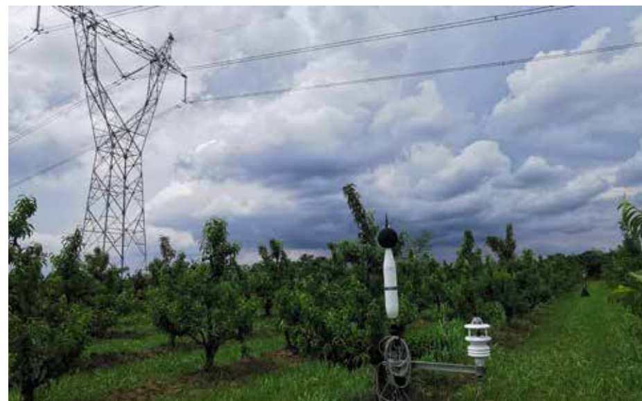
Мерење буке у близини једносистемског надземног вода 400 kV EMC АД
