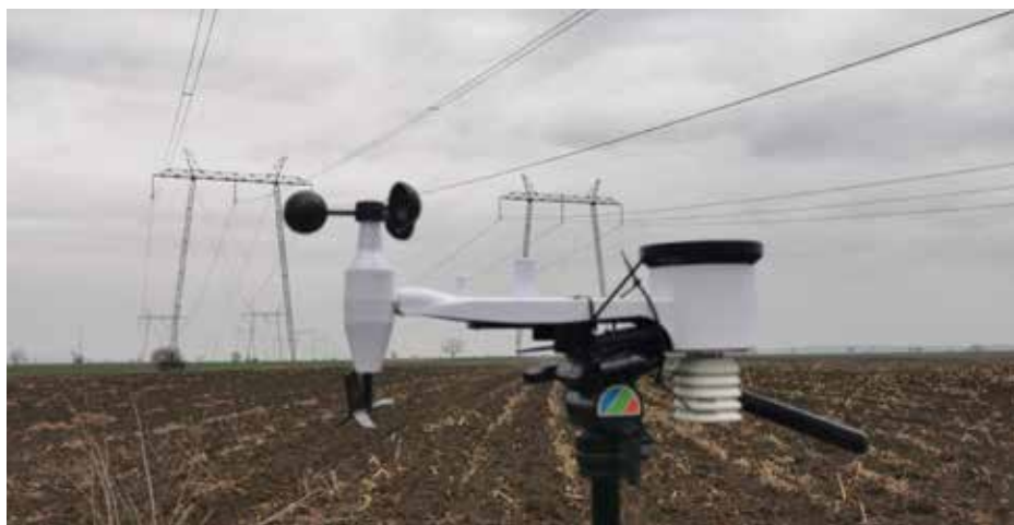
Мерење буке у близини два паралелна надземна једносистемска вода 400 kV EMC АД са метеоролошком станицом
