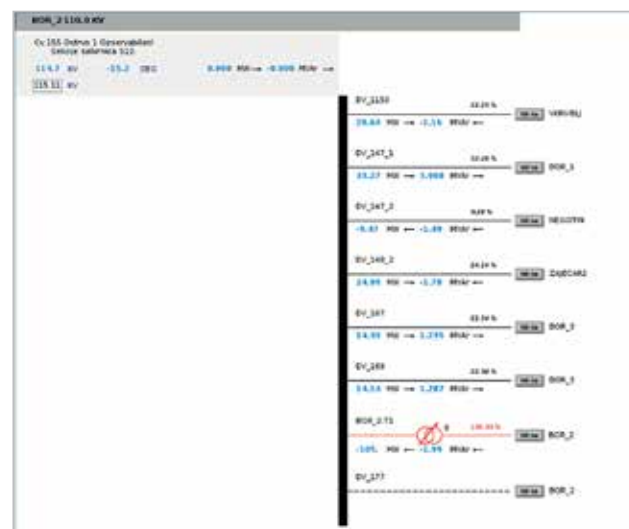
Слика 8 – Трафостаница Бор 2 110 kV пре примене корективних мера
