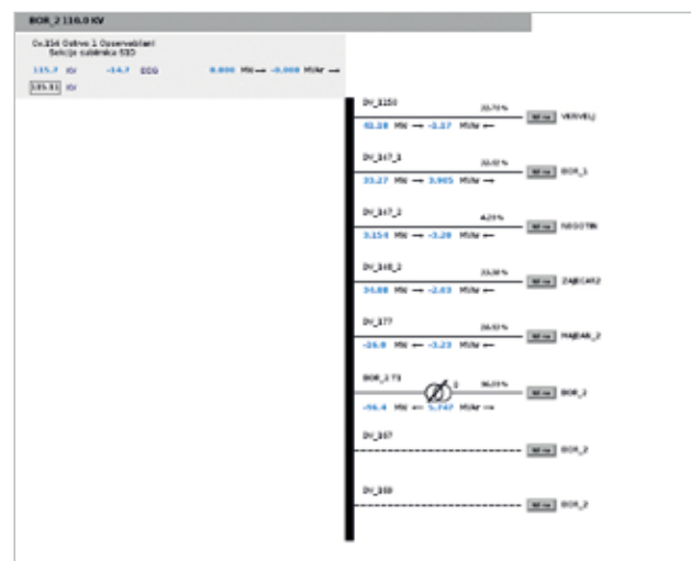
Слика 14 - Трафостаница Бор 2 на 110 kV страни након примене корективних акција
