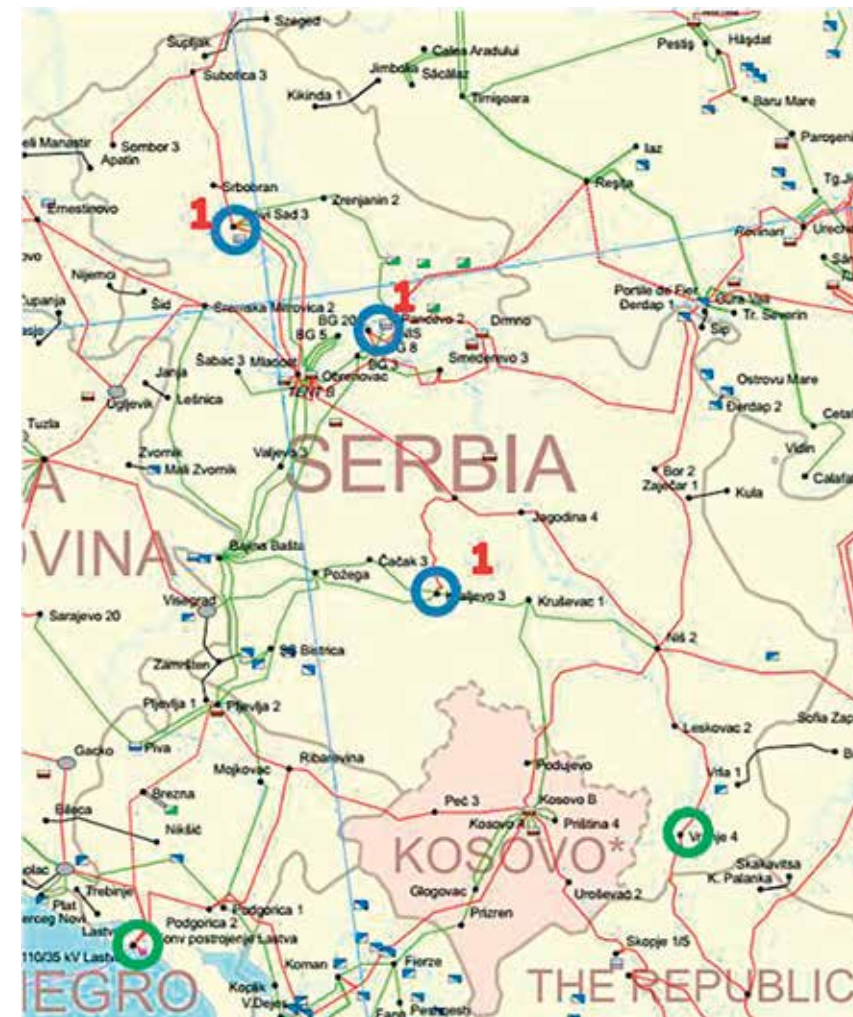
Слика 1: Географски приказ резултата оптимизационог прорачуна за одређивање места уградње уређаја за компензацију реактивне енергије
