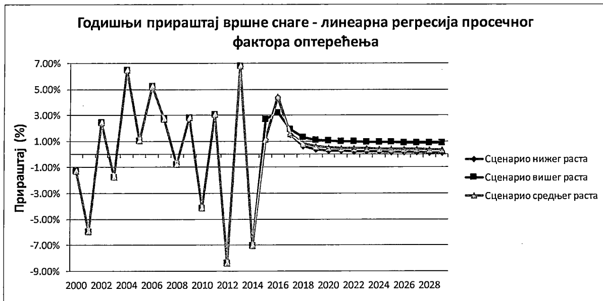
Сл.Д. 4.11: Годишњи прираштај вршне снаге Републике Србије по сценаријима за линеарну регресију просечног фактора оптерећења
