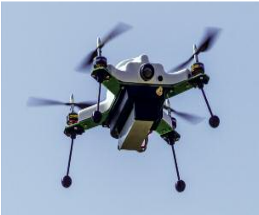
Основна намена летелица без посаде је спровођење визуелних контрола са различитим типовима камера
