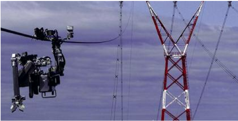
Робот 'LineScout' направљен је у Истраживачком институту "Hydro-Québec" и користи се на електроенергетским водовима, а поседује способност да прелази препреке
