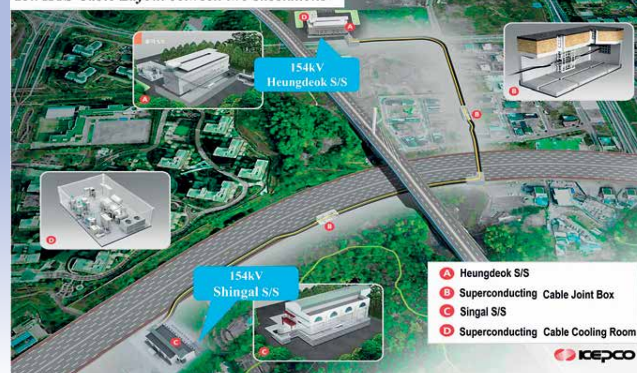
Траса 23 kV HTS кабл између две трансформационе
