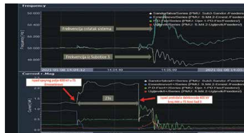
Слика 3: Приказ релевантних података на WAMS систему током поремећаја
