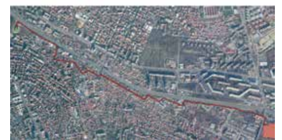
Подземни 110 kV кабловски вод од ТС Београд 17 до ТС Београд 23
