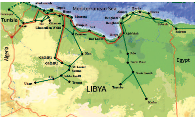
Постојећи преносни систем Либије састоји се од 400 kV и 220 kV надземних водова
