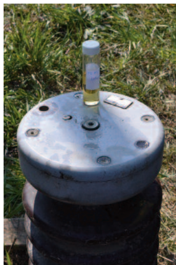
Детаљи узорковања уља из кондензатора
