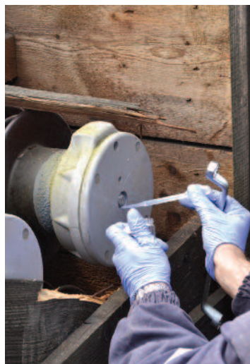
Детаљи узорковања уља из кондензатора
