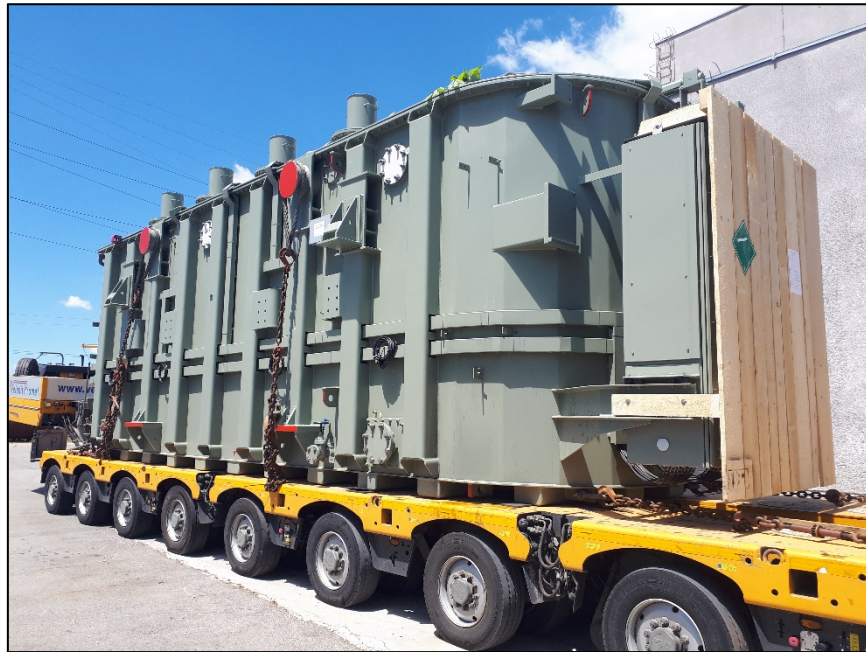
Нови енергетски трансформатор 250MVA
