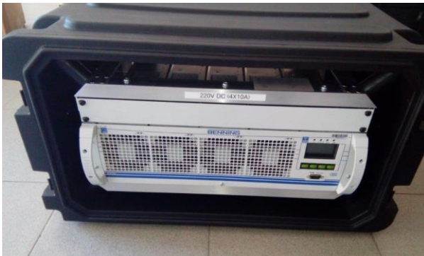
Преносни модуларни исправљач 3x400/230 V, 50 Hz / 220 VDC
