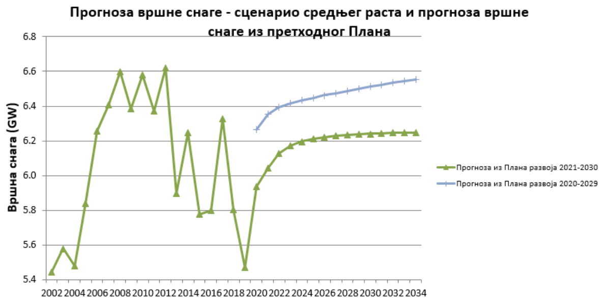
Сл.Д. 4.24: Прогноза вршне снаге Републике Србије без конзумног подручја АП КиМ за сценарио средњег раста за више метода прогнозе фактора оптерећења
